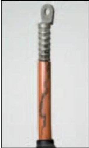
Образец, поврежденный трекинговой дорожкой
